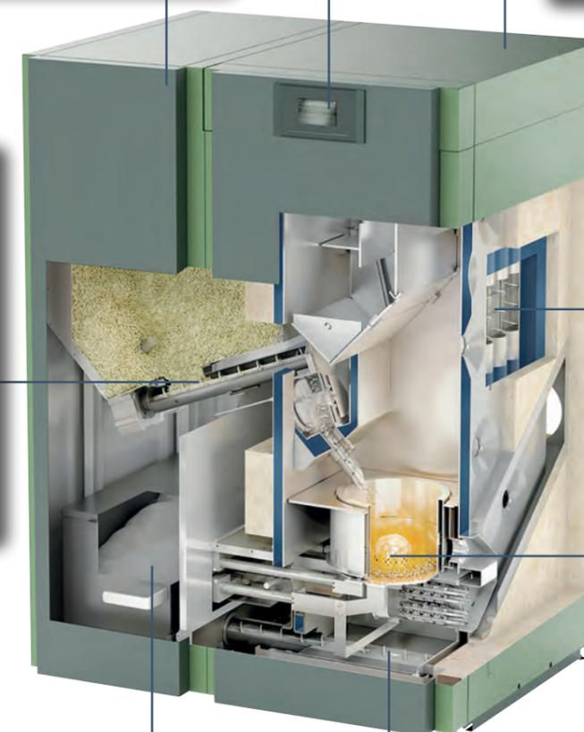
Durch die **vollautomatische Abreinigung** werden die stehenden Wärmetauscherflächen effizient von Verbrennungsrückständen befreit. Die abfallende Asche wird über die vollautomatische Aschenaustragung in den externen Aschenbehälter transportiert.
