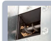
Die Pellets werden bedarfsabhängig über eine getaktete **Dosierschnecke** und über einen nachfolgenden Schrägabwurf dem Brennertopf zugeführt. Die integrierte Zellenrad-Schleuse sorgt dabei für ein Höchstmaß an Betriebssicherheit.
