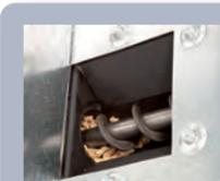
Die Pellets werden bedarfsabhängig über eine getaktete **Dosierschnecke** und über einen nachfolgenden Schrägabwurf dem Brennertopf zugeführt. Die angebaute Temperaturüberwachung mit integriertem Wasserbehälter sorgt dabei für ein Höchstmaß an Betriebssicherheit.
